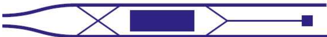
Obr. 30: Úvratové zakončení – průběžná zastávka
